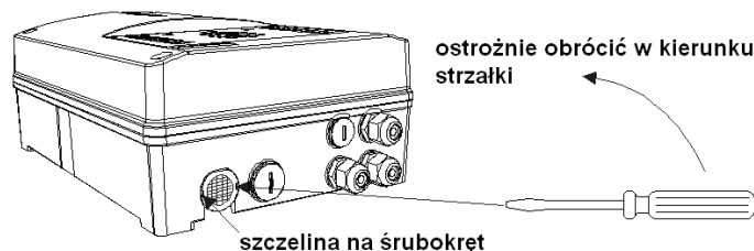
Rys. 19 Usuwanie zaślepki rury wylotu powietrza
